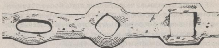
Рис. 17. Последовательность просечки для продевания
